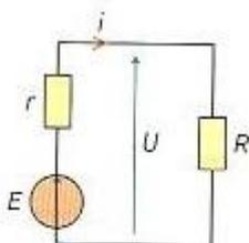
Lorsqu'un générateur électrique de force électromotrice  $E$  (en volts) et de résistance interne  $r$  (en ohms) est relié à une résistance  $R$ , la force  $E$  est égale à  $E = (r + R)i$ , où  $i$  est l'intensité du courant (en ampères).
